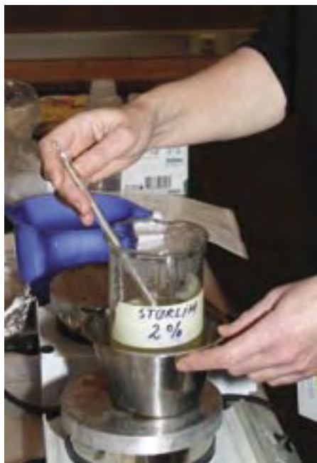
Størlimet skal halde 50 grader før det vert teke i bruk og påført måleriet. (Foto: Johanne Landsverk)
