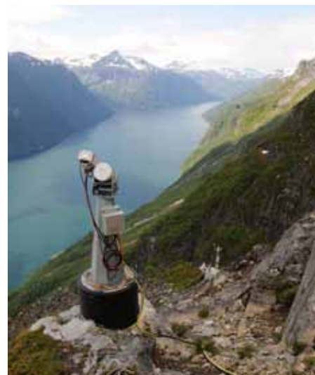
Ein laser måler overflaterørsler på Åkerneset i Stranda i Møre og Romsdal. Når fjellsida før eller seinare skli ut, vil ein ha tid til å evakuere alle som kan bli råka av den påfølgjande flodbølga. (Foto: Tore Bergeng, Åknes/Tafjord Beredskap IKS)
