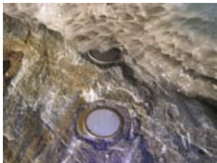
Jordtrykksensorar under breen som kontinuerleg måler trykket frå isen. (Foto: Gaute Lappegard)
